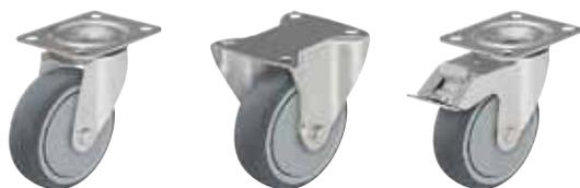
**Gehäuse:** Serie LE/B - Aus Stahlblech gepresst, Lenkgehäuse mit zweifacher Kugellagerung im Drehkranz, mit Drehkranzabdichtung. Die spezielle dynamische Vernietung des Drehkranzes bewirkt ein minimales Drehkranzspiel bei leichtgängigem Lauf und eine hohe Lebensdauer durch die Kaltverfestigung der Kugellaufbahnen.
