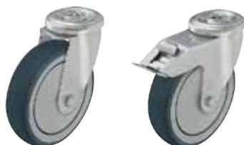
**Gehäuse:** Serie LER - Aus Stahlblech gepresst, mit zweifacher Kugellagerung im Drehkranz, mit stabilem Mittelbolzen, Kugelschutz durch besondere Formgebung der Bodenplatte und Kugelscheibe. Die spezielle dynamische Vernietung des Drehkranzes bewirkt ein minimales Drehkranzspiel bei leichtgängigem Lauf und eine hohe Lebensdauer durch die Kaltverfestigung der Kugellaufbahnen.
