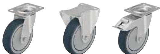
**Gehäuse:** Serie LE/B - Aus Stahlblech gepresst, Lenkgehäuse mit zweifacher Kugellagerung im Drehkranz, mit Drehkranzabdichtung. Die spezielle dynamische Vernietung des Drehkranzes bewirkt ein minimales Drehkranzspiel bei leichtgängigem Lauf und eine hohe Lebensdauer durch die Kaltverfestigung der Kugellaufbahnen.
