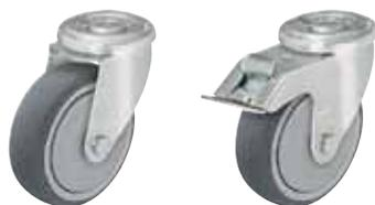
**Gehäuse:** Serie LER - Aus Stahlblech gepresst, mit zweifacher Kugellagerung im Drehkranz, mit stabilem Mittelbolzen, Kugelschutz durch besondere Formgebung der Bodenplatte und Kugelscheibe. Die spezielle dynamische Vernietung des Drehkranzes bewirkt ein minimales Drehkranzspiel bei leichtgängigem Lauf und eine hohe Lebensdauer durch die Kaltverfestigung der Kugellaufbahnen.
