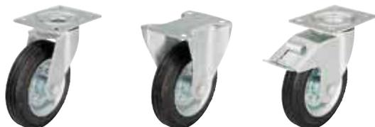
**Gehäuse:** Serie LE/B - Aus Stahlblech gepresst, Lenkgehäuse mit zweifacher Kugellagerung im Drehkranz, mit Drehkranzabdichtung. Die spezielle dynamische Vernietung des Drehkranzes bewirkt ein minimales Drehkranzspiel bei leichtgängigem Lauf und eine hohe Lebensdauer durch die Kaltverfestigung der Kugellaufbahnen. Radachse verschraubt. Galvanisch verzinkt, blau passiviert, Cr6-frei. Gehäuseübersicht: Seite 64 Zeichnungen Anschraubplatten: Seite 77 Rad- und Drehkranzbremse "stop-fix": Seite 80
