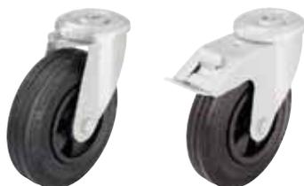
**Gehäuse:** Serie LER - Aus Stahlblech gepresst, mit zweifacher Kugellagerung im Drehkranz, mit stabilem Mittelbolzen, Kugelschutz durch besondere Formgebung der Bodenplatte und Kugelscheibe. Die spezielle dynamische Vernietung des Drehkranzes bewirkt ein minimales Drehkranspiel bei leichtgängigem Lauf und eine hohe Lebensdauer durch die Kaltverfestigung der Kugelaufbahnen.
