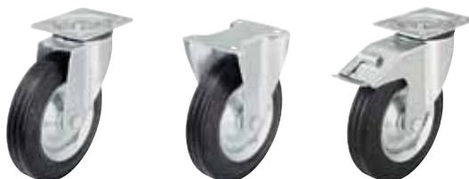
**Gehäuse:** Serie L/B/BH - Aus Stahlblech gepresst, Lenkgehäuse mit zweifacher Kugellagerung im Drehkranz, mit stabilem Mittelbolzen (Rad-Ø 160-280 mm), mit Drehkranzabdichtung (Ausnahme: Plattengröße 175x175 mm). Die spezielle dynamische Vernietung des Drehkranzes bewirkt ein minimales Drehkranzspiel bei leichtgängigem Lauf und eine hohe Lebensdauer durch die Kaltverfestigung der Kugellaufbahnen.
