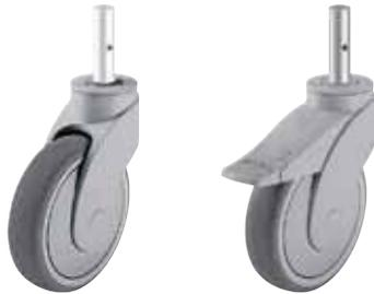
**Gehäuse:** Serie LWG - Aus hochwertigem , bruchfestem und verstärktem Polyamid 6 , mit eingespritztem , doppelt abgedichtetem Rillenkugellager im Drehkranz , mit galvanisch verzinktem , blau passiviertem Stahl-Einsteckzapfen (Cr6-frei) verschraubt und gesichert , silbergrau RAL 7001 . Modernes , formschönes Design.
