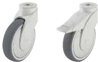
**Gehäuse:** Serie LWK - Aus hochwertigem, bruchfestem und verstärktem Polyamid 6, mit eingespritztem, doppelt abgedichtetem Rillenkugellager im Drehkranz, mit Rückenloch, grauweiß RAL 9002.
