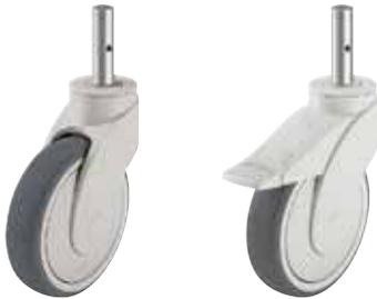
**Gehäuse:** Serie LWK - Aus hochwertigem , bruchfestem und verstärktem Polyamid 6 , mit eingespritztem , doppelt abgedichtetem Rillenkugellager im Drehkranz , mit galvanisch verzinktem , blau passiviertem Stahl-Einsteckzapfen (Cr6-frei) verschraubt und gesichert , grauweiß RAL 9002 . Modernes , formschönes Design.
