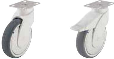
**Gehäuse:** Serie LWKX - Aus hochwertigem , bruchfestem und verstärktem Polyamid 6 , mit eingespritztem , doppelt abgedichtetem rostfreiem Rillenkugellager im Drehkranz , mit Anschraubplatte aus rostfreiem Stahl , grauweiß RAL 9002 . Sämtliche Einzelteile inkl . Achsmaterial sind rostbeständig.
