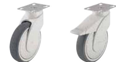
**Gehäuse:** Serie LWK - Aus hochwertigem , bruchfestem und verstärktem Polyamid 6 , mit eingespritztem , doppelt abgedichtetem Rillenkugellager im Drehkranz , mit galvanisch verzinkte , blau passivierter Stahl-Anschraubplatte (Cr6-frei) , grauweiß RAL 9002 .
