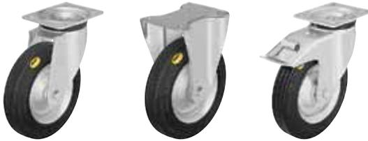
**Gehäuse:** Serie LK/BK/BH - Aus starkem Stahlblech gepresst , Lenkgehäuse mit zweifacher Kugellagerung im Drehkranz , mit stabilem Mittelbolzen (Rad-Ø 160-200 mm), mit Drehkranzabdichtung . Die spezielle dynamische Vernietung des Drehkranzes bewirkt ein minimales Drehkranzspiel bei leichtgängigem Lauf und eine hohe Lebensdauer durch die Kaltverfestigung der Kugellaufbahnen. Radachse verschraubt.
