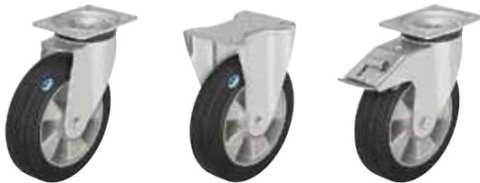
**Gehäuse:** Serie LK/BK/BH - Aus starkem Stahlblech gepresst , Lenkgehäuse mit zweifacher Kugellagerung im Drehkranz , mit stabilem Mittelbolzen (Rad-Ø 125x50 - 200 mm) , mit Drehkranzabdichtung . Die spezielle dynamische Vernietung des Drehkranzes bewirkt ein minimales Drehkranzspiel bei leichtgängigem Lauf und eine hohe Lebensdauer durch die Kaltverfestigung der Kugellaufbahnen.
