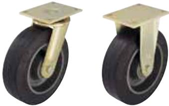
**Gehäuse:** Serie LS/BS - Besonders robuste Stahlschweißkonstruktion , Lenkgehäuse mit Axial-Rillenkugellager DIN 711 und Kegelrollenlager DIN 720 im Drehkranz , staub- und spritzwassergeschützt , mit Schmiernippel , mit eingeschweißtem , sehr stabilem Mittelbolzen verschraubt und gesichert.
