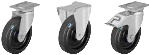
**Gehäuse:** Serie LU/BH - Aus starkem Stahlblech gepresst , Lenkgehäuse mit Vierpunkt-Kugellagerung im Drehkranz für eine optimale Aufnahme von vertikalen und horizontalen Kräften , geschlossener, abgedichteter Drehkranz . Die Verwendung von gehärteten Lagerschalen in Verbindung mit der speziellen dynamischen Vernietung erhöht die Robustheit gegen Stöße und Schläge und bewirkt einen leichtgängigen Lauf bei geringem Verschleiß und hoher Lebensdauer .
