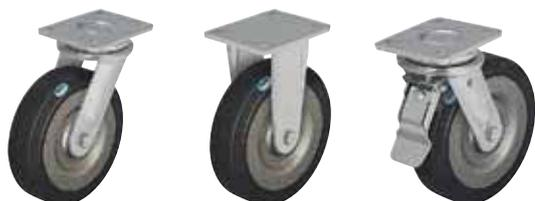
**Gehäuse:** Serie LO/BO - Solide Stahlschweißkonstruktion, Lenkgehäuse mit zweifacher Kugellagerung im Drehkranz, zusätzlich verstärkt durch vier speziell geformte und gehärtete Lagerschalen, Drehkranzabdichtung durch Labyrinthbauweise, mit Schmiernippel, mit eingeschweißtem, sehr stabilem Mittelbolzen verschraubt und gesichert.
