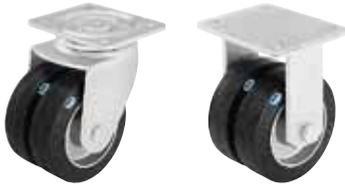
**Gehäuse:** Serie LHD/BOD - Lenkgehäuse aus starkem Stahlblech gepresst , mit schwerer Gabel und Anschraubplatte , mit sehr stabilem Mittelbolzen verschraubt und gesichert , mit zweifacher Kugellagerung im Drehkranz , zusätzlich verstärkt durch **vier speziell geformte , gehärtete Lagerschalen** , dadurch besonders unempfindlich gegen Stöße und Schläge .
