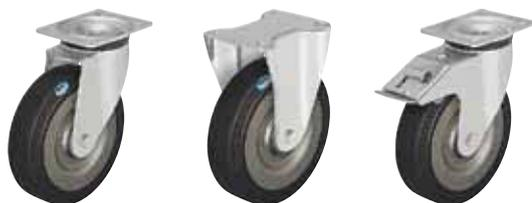
**Gehäuse:** Serie LK/BK/BH - Aus starkem Stahlblech gepresst , Lenkhäuser mit zweifacher Kugellagerung im Drehkranz , mit stabilem Mittelbolzen (Rad-Ø 125-200 mm), mit Drehkranzabdichtung . Die spezielle dynamische Vernietung des Drehkranzes bewirkt ein minimales Drehkranzspiel bei leichtgängigem Lauf und eine hohe Lebensdauer durch die Kaltverfestigung der Kugellaufbahnen. Radachse verschraubt.
