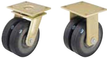
**Gehäuse:** Serie LSD/BS - Besonders robuste Stahlschweißkonstruktion, Lenkgehäuse mit Axial-Rillenkugellager DIN 711 und Kegelrollenlager DIN 720 im Drehkranz, staub- und spritzwassergeschützt, mit Schmiernippel, mit eingeschweißtem, sehr stabilem Mittelbolzen verschraubt und gesichert.
