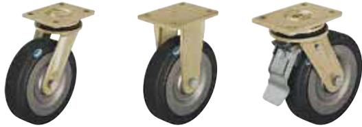
**Gehäuse:** Serie LS/BS - Besonders robuste Stahlschweißkonstruktion, Lenkgehäuse mit Axial-Rillenkugellager DIN 711 und Kegelrollenlager DIN 720 im Drehkranz, staub- und spritzwassergeschützt, mit Schmiernippel, mit eingeschweißtem, sehr stabilem Mittelbolzen verschraubt und gesichert.
